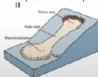
Earthflow Flujo de tierra
